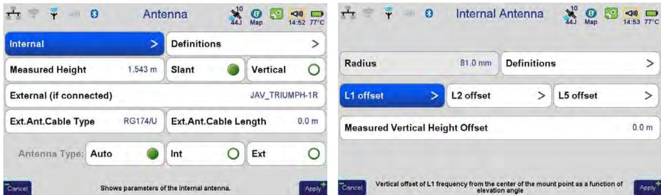
**Figure 9. Antenna parameters**
